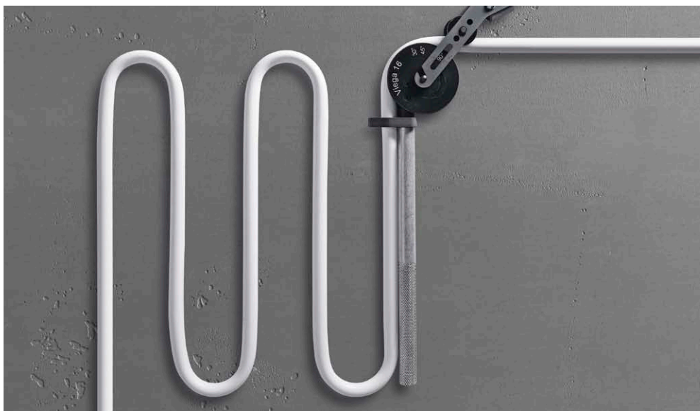
С инструмента за огъване можете лесно да създавате чисти радиуси.
